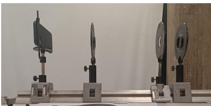
Figura 8 Microscopio ottico a) realizzato orizzontalmente b) realizzato verticalmente in analogia ai microscopi ottici reali
